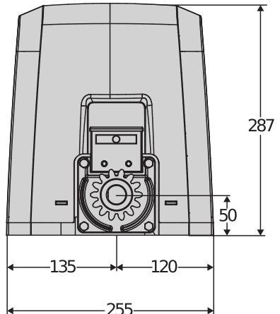
Yana kayar konut kapısı operatörleri ürün gamı. Elektromekanik limit anahtarı ve 230V besleme
