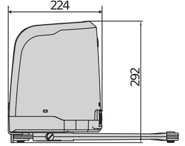
Azami 2 metre genişliğinde ve 200 kg ağırlığındaki kanatlı bahçe kapıları için uygun, mesken tipi kullanıma yönelik mafsalı kollu elektromekanik operatör.
